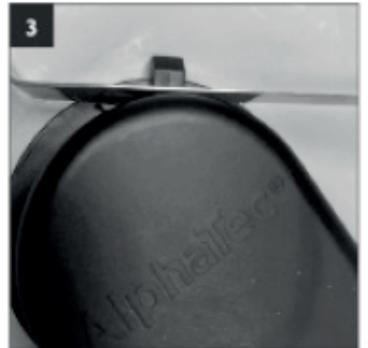
Volg deze instructies om de kap van de AlphaTec® uitlaatklep te verwijderen. Leg het pak uit op een vlakke ondergrond en zoek de uitlaatkleppen aan de achterkant van de kap. [Wanneer u het kleppendecksel verwijdert, mag u de binnenste borgingskragen NIET vasthouden, want dan kan de klep loskomen van het pak.
