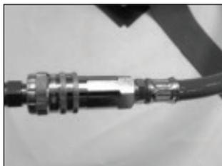
Raccordement du tuyau à l'ARI
