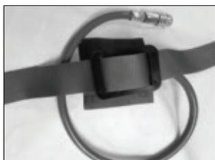
Interner Nabelschlauch zum Anschluss an SCBA
